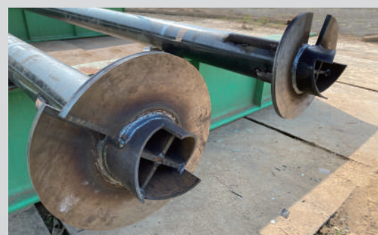
実戦投入に備え着々と試験をクリアするプロトタイプ。先端内部の十文字が力強さと揺るぎない安心感を与えてくれる
